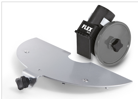
Sada krytu na odsávání při práci s reznými kotouči pro úhlovou brusku 230 mm. Skládá se z odsávání s vodícím kolem a hliníkového víka. Bez
